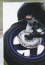
Le train avant est doté avec un disque et une fourche hydraulique et des roues de 12".
